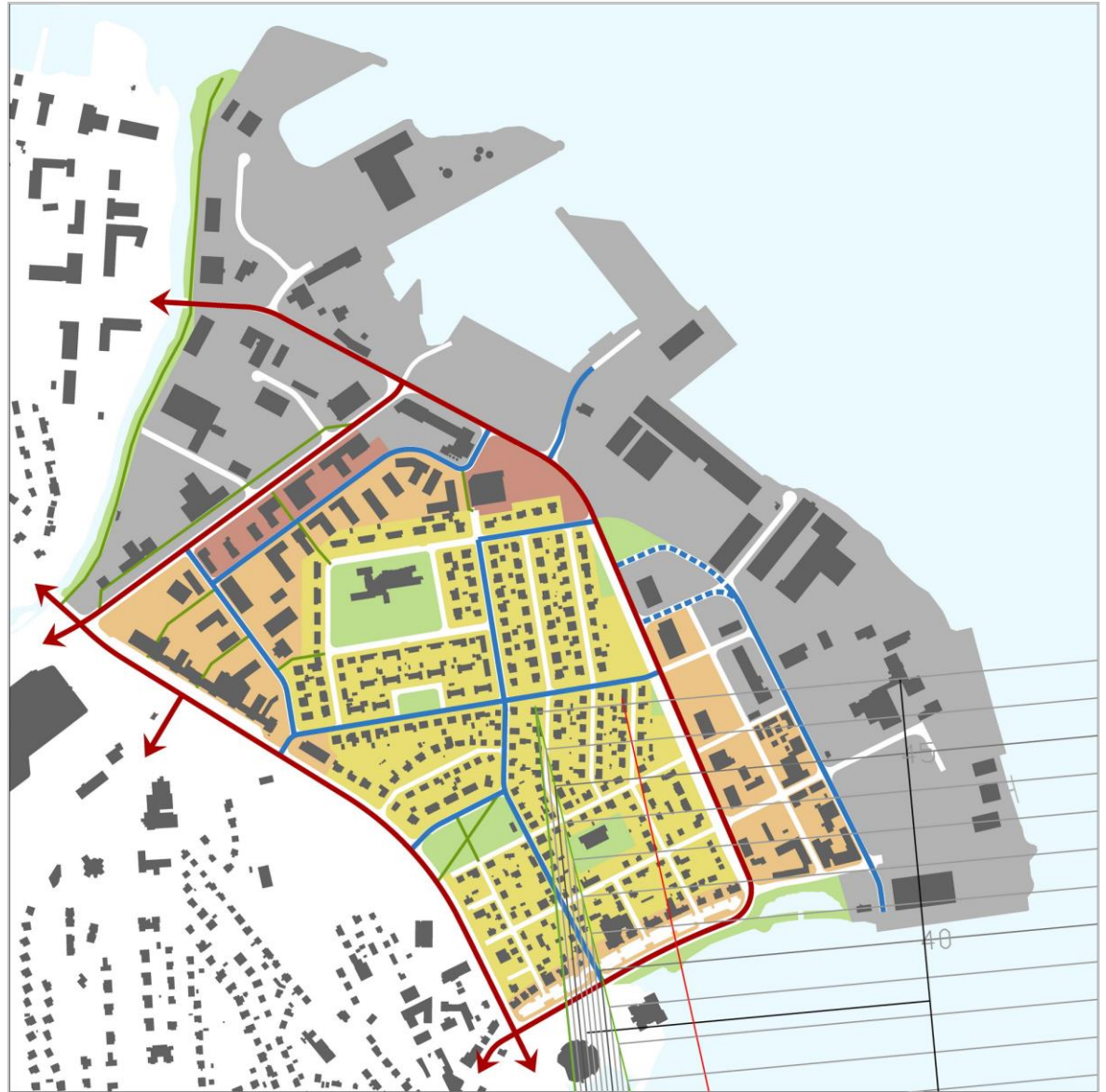
7. mynd. Hindranasvæði flugvallar sýnt á uppdrætti. Utan merka svæðisins eru hæðartakmörk 47,18 m.y.s. á láréttum fleti.
